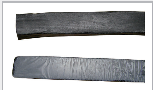
Vergleich Quellband mit und ohne Schutzhülle
