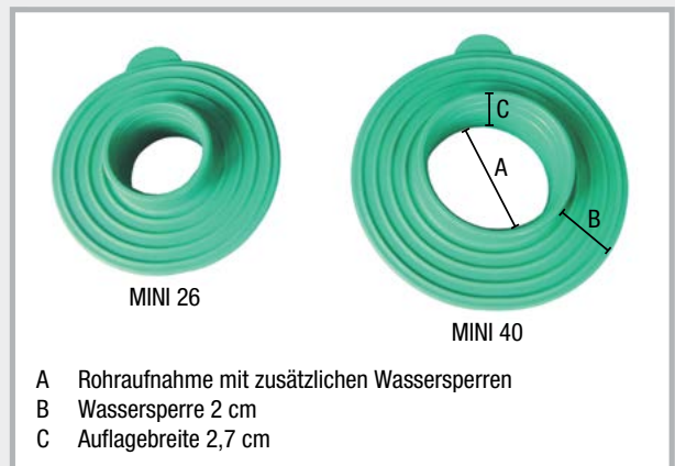
Druckwasserdicht bis 30 m Wassersäule
