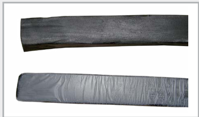
Vergleich Quellband mit und ohne Schutzhülle
