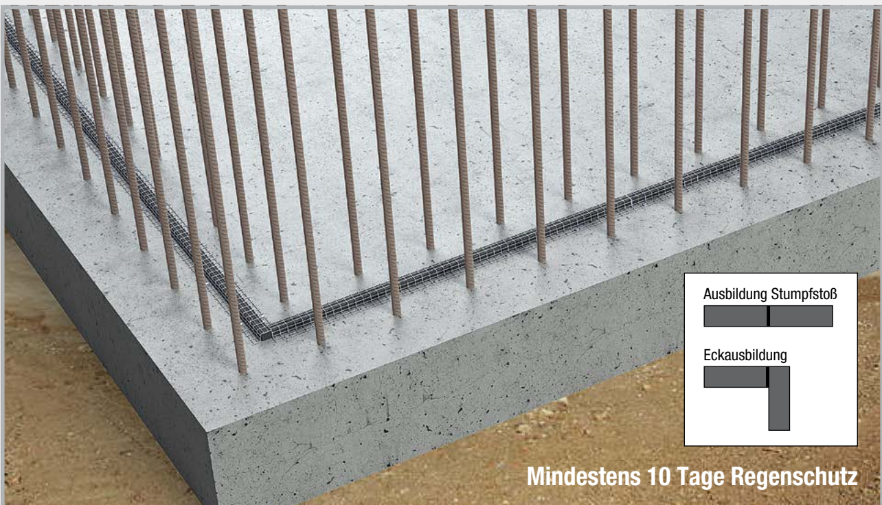
Einbau MASTERSTOP LONG TIME mit Quellbandgitter Betondeckung 8 cm innerhalb der Bewehrung
