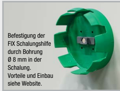
Befestigung ohne Schraub- adapter mit Nägeln. Für eine leichte Entschalbarkeit keine Schrauben verwenden.
