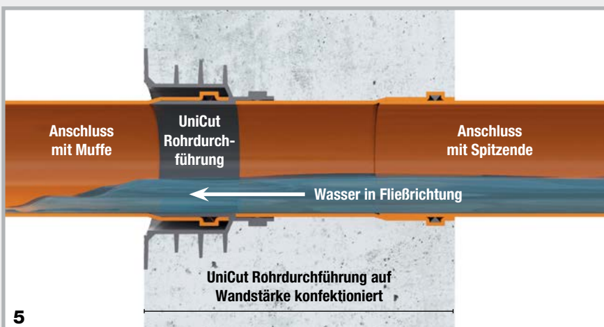
6 Die Abflussrohre in KG oder KG 2000 können links in das Muffenende und rechts in das Spitzende eingeschoben werden.
