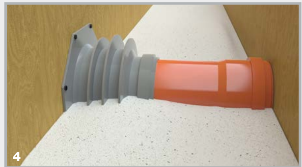
4 Betonage und sorgfältige Verdichtung
