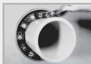
Serrer d'un tour toutes les vis, les unes après les autres, jusqu'à ce que tous les modules soient fixés de manière uniforme.
