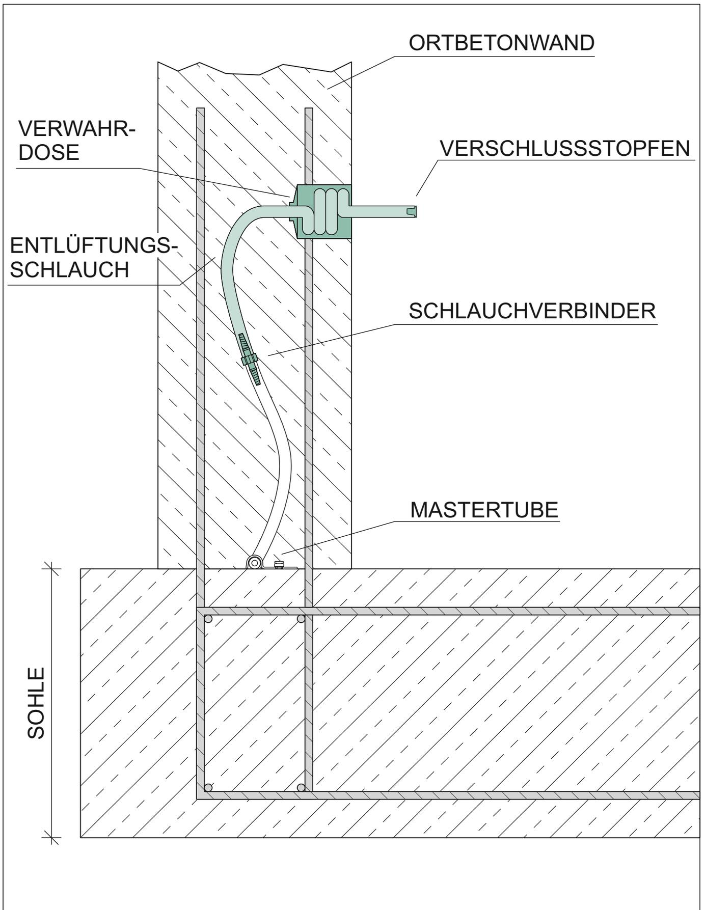
SCHLAUCHVERBINDER / ENTLÜFTUNGSSCHLAUCH
