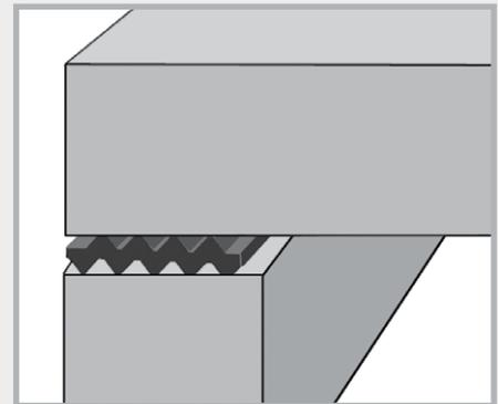
Appui ondulé entre deux éléments de construction
