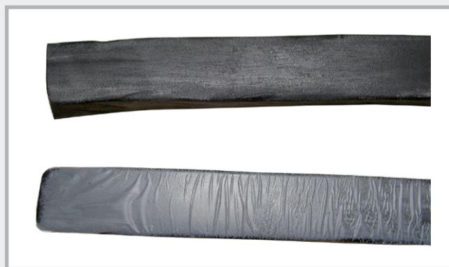
Comparaison du joint hydrogonflant avec et sans gaine de protection
