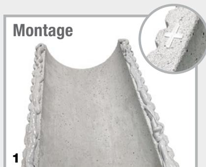
1. Placer les écarteurs fournis sur l'arête de coupe de la coque inférieure et appliquer la colle à béton PROTECT Easy 1K (n° d'art. 040030) sur les arêtes de coupe (quantité : env. 150 g/m de chaque côté). La colle à béton PROTECT Easy 1K doit être commandée séparément.
