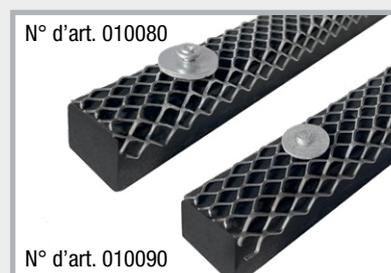
Poser la grille sur le joint hydrogonflant à la bentonite MASTERSTOP et la fixer sur le béton à l'aide de clous. Les clous peuvent être fixés manuellement ou avec un pistolet à clous. La distance entre les clous ne doit pas dépasser 20 cm.
