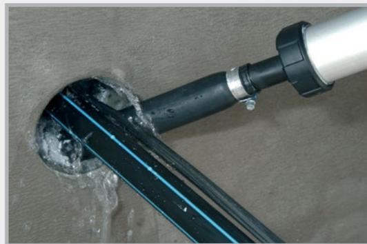
**Étanchéité testée dans l'espace annulaire (MFPA Leipzig) jusqu'à une colonne d'eau de 7,5 m**
