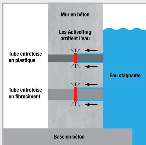
Fonctionnement des ActiveRing : Le contact avec l'eau active les rondelles qui se dilatent ; la pression de gonflement ainsi générée arrête l'écoulement de l'eau et assure l'étanchéité. En cas de contact avec l'eau, l'étanchéité reste durablement active.
