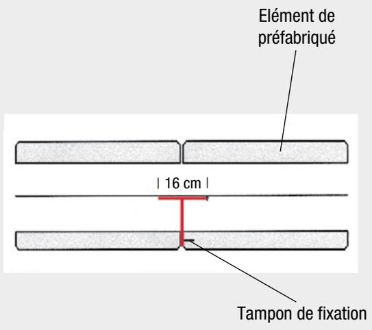
Les éléments sont livrés complètement prémontés et sont fixés au coffrage intérieur des éléments préfabriqués à l'aide de chevilles à frapper comprises dans la livraison. Les éléments sont reliés dans la partie inférieure à l'étanchéité du radier.
