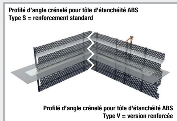
Les profils d'angle rugueux/crénelés pour tôle d'étanchéité ABS sont utilisés pour réaliser les angles au niveau du coffrage du radier. Les profils d'angle rugueux/crénelés pour tôle d'étanchéité ABS sont livrés prêts au montage et adaptés à la hauteur de radier. Ils sont compatibles avec les éléments de coffrage ABS rugueux/crénelés pour tôle d'étanchéité.
