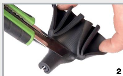
Extraire le segment de rondelle d'oignon à retirer et le sectionner avec un cutter.
