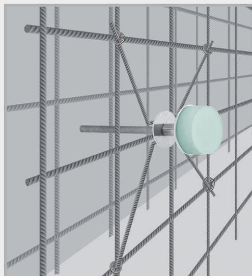
Point de prise de terre avec dispositif de fixation à l'armature
