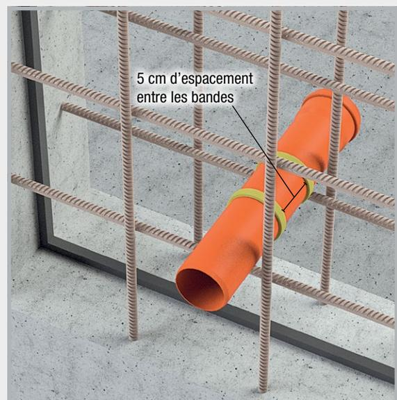
MASTERSTOP SK est collé à l'intérieur de l'armature avec un enrobage en béton de 6 cm autour du tube.
