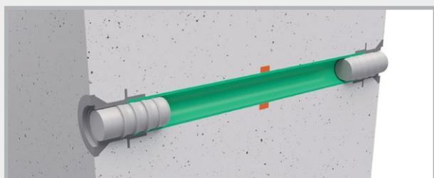
Test de résistance à l'eau sous pression jusqu'à une colonne d'eau de 30 m
