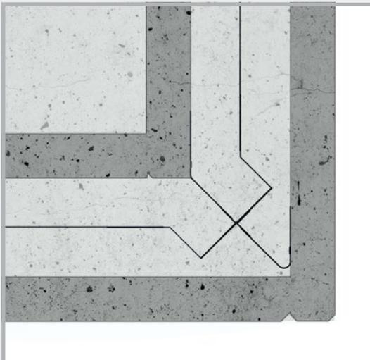
Montage en angle possible jusqu'à une largeur de voile de 300 mm
