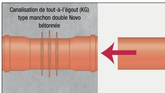
Le manchon double est bétonné. Après le bétonnage, les couvercles de fermeture sont retirés et les étanchéités sont posées. Le tube suivant peut ensuite être raccordé.
