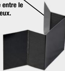
Dans la zone angulaire, le passage de la tôle d'étanchéité radier/voile doit être réalisé de façon à ce que l'élément de joint de rupture puisse être mis en place à la verticale de l'interstice. Pour la réalisation de l'angle, nous recommandons l'utilisation de l'angle FB de tôle d'étanchéité VB (n° d'art. 070224).
