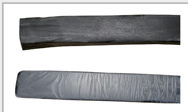
Vergleich Quellband mit und ohne Schutzhülle
