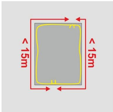
Der Injektionsschlauch **MASTERTUBE "YELLOW"** dient als innenliegende Fugenabdichtung von Arbeitsfugen.
