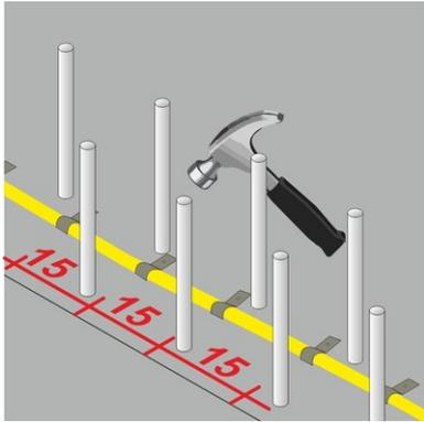
Der Injektionsschlauch **MASTERTUBE "YELLOW"** muss so fixiert werden, dass vor und während der Betonage keine Lageänderung des Injektionsschlauchs möglich ist. Die Befestigung ist mittels Metallschellen oder Kunststoffbefestigungsclips möglich. Der Abstand der gewählten Befestigung darf in Längsrichtung 15 cm nicht überschreiten. Bei sehr unebenem Untergrund und an jeder Richtungsänderung ist der Abstand zu halbieren.
