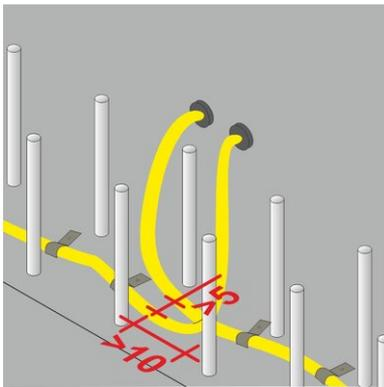
In die Enden der Schlauchabschnitte werden Befestigungspacker bis zum Gewindeende eingeschraubt und an der Schalhaut befestigt. Die Position des Befestigungspackers sollte so gewählt werden, dass sie dauerhaft erreichbar ist (Fußbodenaufbau und TGA Installation berücksichtigen). Die Befestigungspacker verfügen über Verschlusskappen in 2 verschiedenen Farben. Diese können zur Markierung im Verpresskreislauf zusammengehöriger Befestigungspacker genutzt werden.
