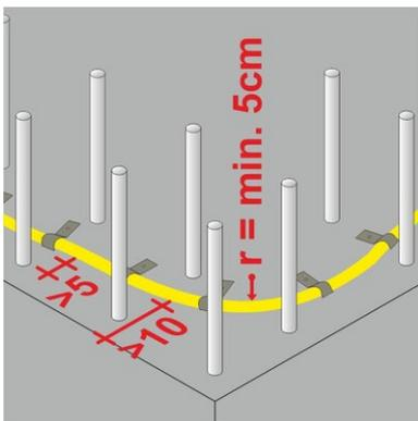
Richtungsänderungen sind mit einem ausreichenden Biegeradius auszuführen, um eine Beschädigung des Schlauches bzw. eine Behinderung der ganzheitlichen Verpressung zu vermeiden. Ein Radius von 5 cm darf nicht unterschritten werden.
