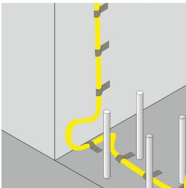
Bei einem Wechsel zwischen horizontaler und vertikaler Verlegerichtung ist der Injektionsschlauch bis direkt in die Fugenecke zu führen und über eine Schlaufe nach oben zu führen. Der minimale Radius sowie die Betonüberdeckung ist einzuhalten.
