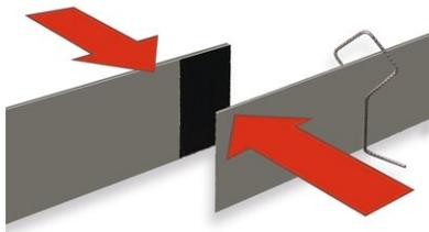
An beiden Blechenden ist eine 7,5 cm breite, hochklebende Stoßverbindung aufgebracht. Die Stoßverbindung gewährleistet einen sicheren, wasserundurchlässigen Verbund der Abdichtungsbleche untereinander.
