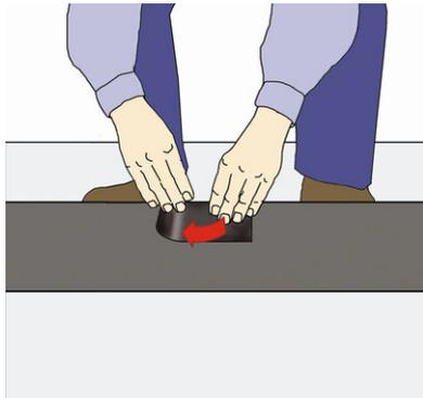
Für den Anschluss von Blechen in der aufgehenden Wand wird an der entsprechenden Stelle das Stoßverbindungsklebeband aufgeklebt und entsprechend der Überlappungsstöße miteinander verklebt. Hier ist eine Sicherung mit 2 Stoßklammern notwendig.
