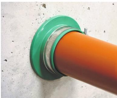
Anschließend die Spannschelle über die Anschlussdichtung legen und das anzuschließende Medienrohr durch die Dichtung schieben und durch das handfeste Anziehen der Spannschelle sichern.
