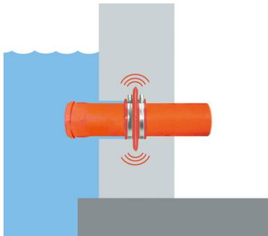
Der **RONDO Protect Mauerkragen** sitzt mittig im Betonbauteil. Ein Wasserdurchtritt an der Rohraußenwandung wird sicher und dauerhaft verhindert
