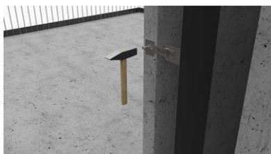
L'onglet de retenue est fixé avec un tampon de fixation.
