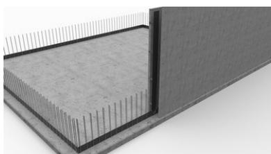
Le **profilé SFG** est prémonté, l'élément de mur creux suivant peut être mis en place.
