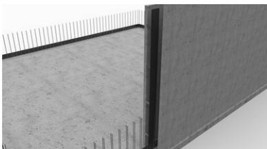
Le profilé SFG est mis en place à la verticale et recouvre la tôle d'étanchéité (recouvrement  $\geq 5$  cm).
