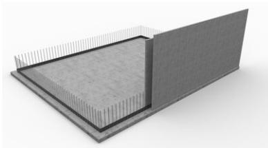
Pose du premier élément de mur creux. L'étanchéité base/mur est réalisée avec une tôle d'étanchéité VB.
