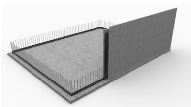
Le **profilé SRF** est mis en place à la verticale et recouvre la tôle d'étanchéité (recouvrement  $\geq$  5 cm).
