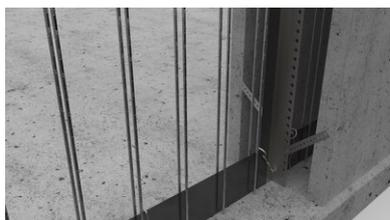
La zone prévue pour le chevauchement des joints sur la tôle d'étanchéité base/mur est protégée par deux goupilles de sécurité.
