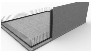
Le **profilé SFG** est prémonté, l'élément de mur creux suivant peut être mis en place.
