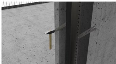
L'onglet de retenue est fixé avec un tampon de fixation.
