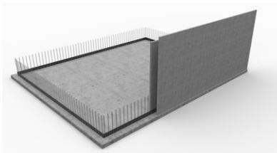
Pose du élément de mur creux. L'étanchéité base/mur est réalisée avec une tôle d'étanchéité VB.
