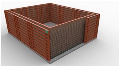
Pose d'un élément de paroi en béton coulé sur place.
