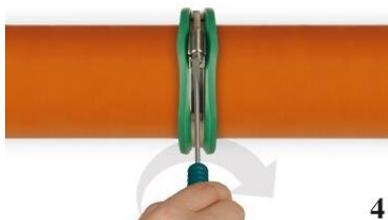
La bande de serrage est serrée avec un couple d'environ 5 à 6 Nm de manière à ce que le **RONDO Base** ne puisse plus être déplacé lors du bétonnage.
