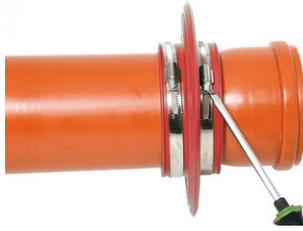
Les bandes de serrage sont serrées à l'aide d'un tournevis de manière à ce que le **collier mural RONDO Protect** ne puisse plus être déplacé lors du bétonnage.
