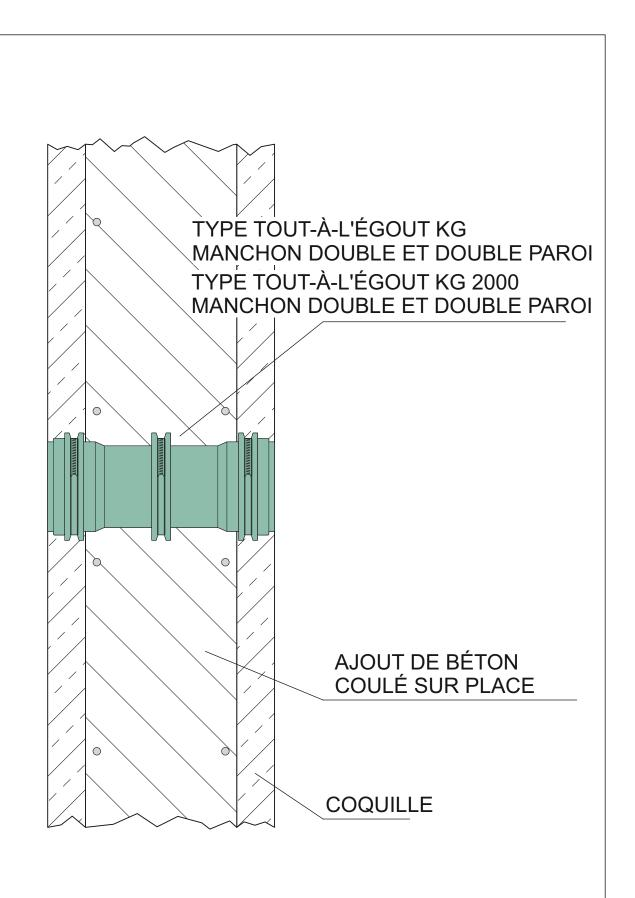
TYPE TOUT-À-L'ÉGOUT KG MANCHON DOUBLE ET DOUBLE PAROI / TYPE TOUT-À-L'ÉGOUT KG 2000 MANCHON DOUBLE ET DOUBLE PAROI dans paroi en éléments préfabriqués
